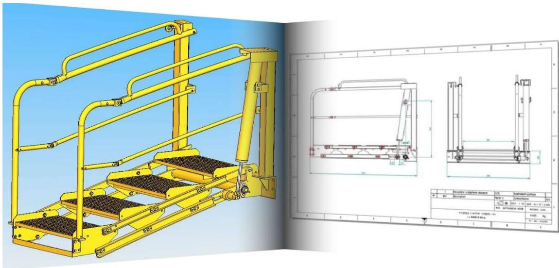
Assemblage et mise en plan d'une passerelle
